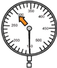
Das Prüflast ohne Last-Zeit-Diagramm (z.B. Kipptester) hat einen Kraftanzeiger, auf dem der Bediener die aufgebrachte Kraft ablesen kann. Das Gerät verfügt über einen Schleppzeiger. Nach Beendigung der Kraftmessung bleibt der Zeiger bei der maximalen Belastung stehen. Alternativ kann über einen Signalton das Erreichen der geforderten Prüflast kontrolliert werden.
